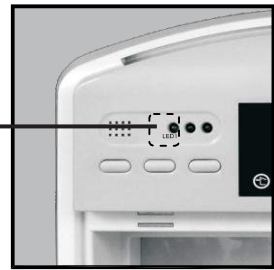
Lysdiode for skifte av HEPA-filter
