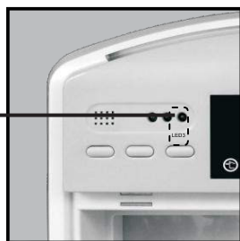
Lysdiode for udskiftning af kulfilter
